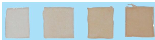
写真1 染色された「赤土パッチ・テスター」の例 (10分間浸漬、左から67, 200, 600, 1800 mg/L)
